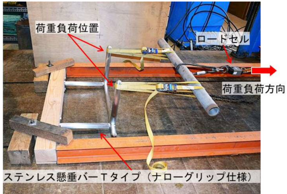
図1 耐荷重試験状況
